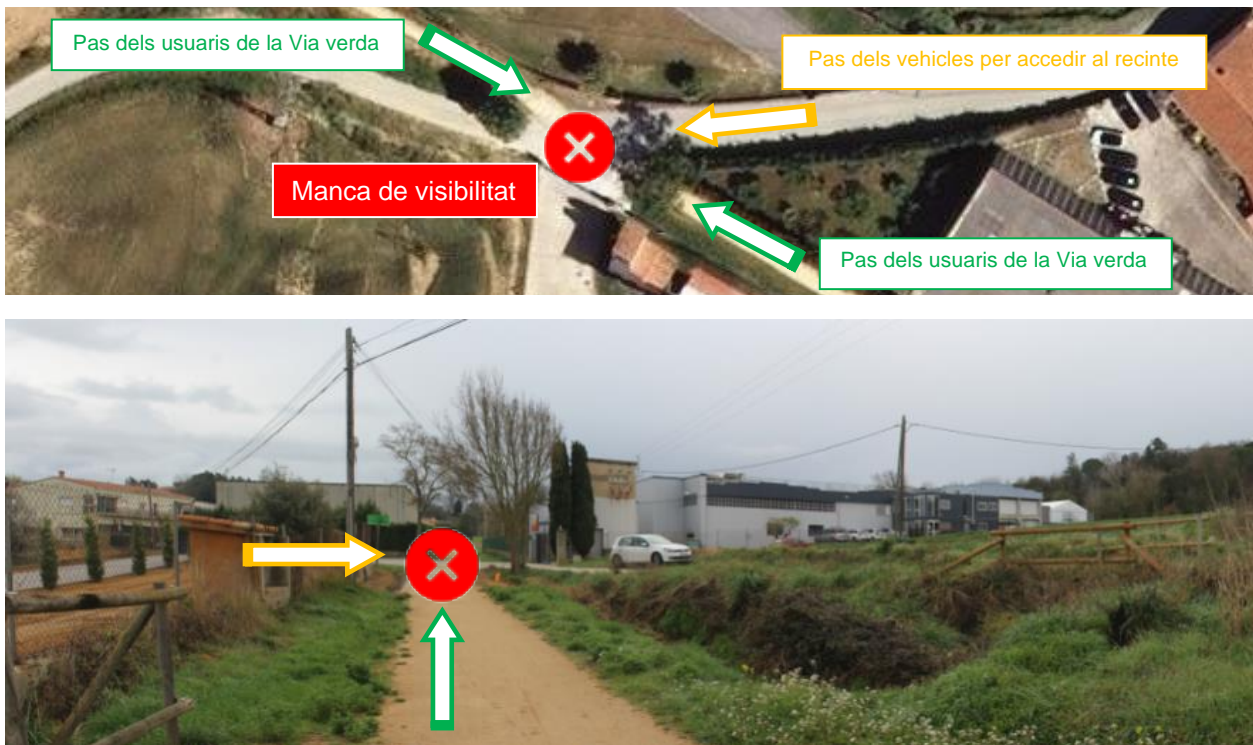
Figura 7. Intersecció de la Via verda amb el camí de les Brugueres.
